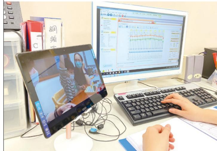
圖1 遠距調頻，施作地點需具備可連至電子耳專用調頻軟體的電腦以及視訊設備。
